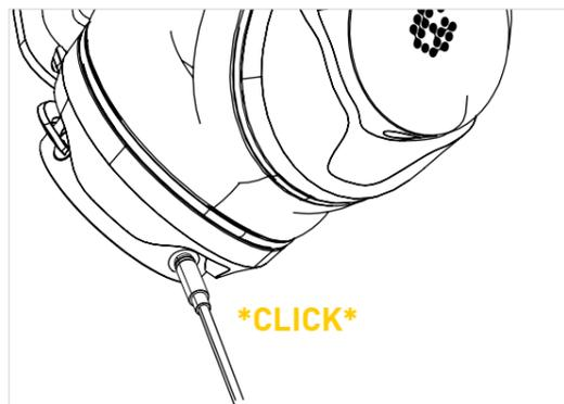
→ Pour retirer ou remplacer le câble, tirez-le délicatement hors du connecteur à l'aide du barillet du connecteur jack et non du câble.
