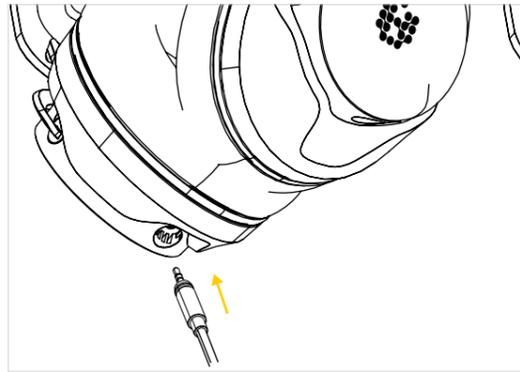
→ Insérez le câble de raccordement dans l'un des connecteurs jusqu'à ce qu'il se verrouille en position avec un clic audible.
