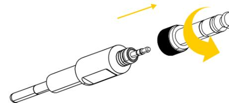
→ Raccordez l'adaptateur au câble en le tournant dans le sens des aiguilles d'une
