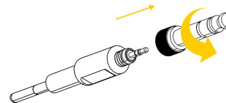
→ Fissare l'adattatore al cavo ruotandolo in senso orario.
