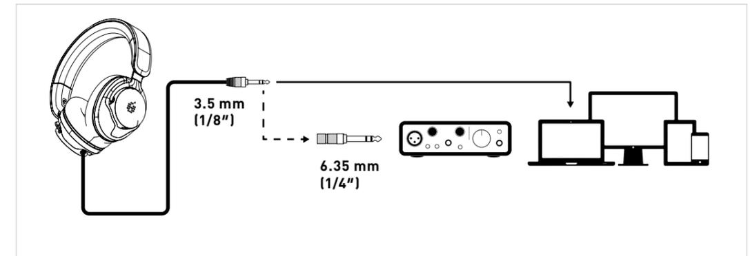
→ Collegare l'H200 all'uscita delle cuffie, ad esempio un amplificatore per cuffie dedicato, l'uscita delle cuffie dell'interfaccia audio, il mixer, il dispositivo di ascolto portatile o il computer.
